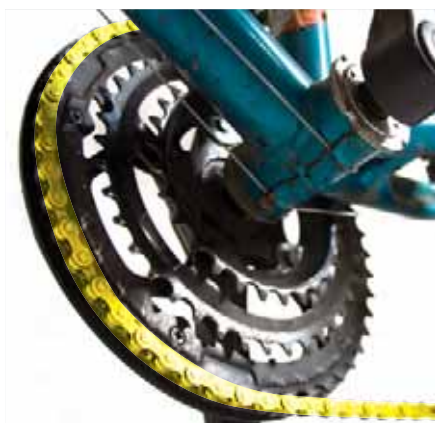
Quando tu cadena va en la estrella delantera más grande, el pedaleo se hace más pesado pero avanzas más. Ideal en bajadas.
