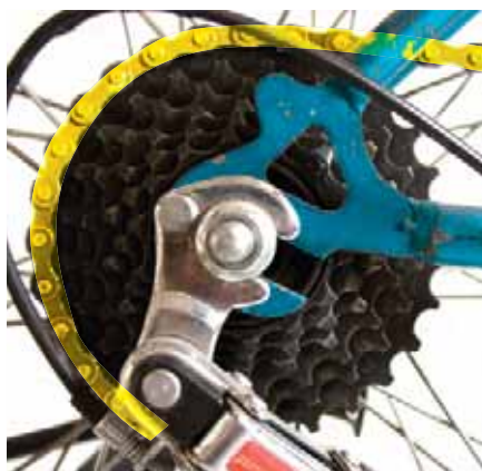
Quando tu cadena va en la estrella trasera más grande, el pedaleo es más fácil y avanzas menos. Ideal para subidas.
