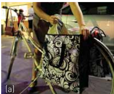
Una parrilla trasera en la que puedes colocar alforjas (a), una mochila con ganchos o con resortes (b), o una caja (d), es la mejor opción para carga pesada porque no desestabiliza a la bicicleta. Si amarras algo, cuida de no sujetar, doblar o tensar de más los cables de los frenos o los cambios.
