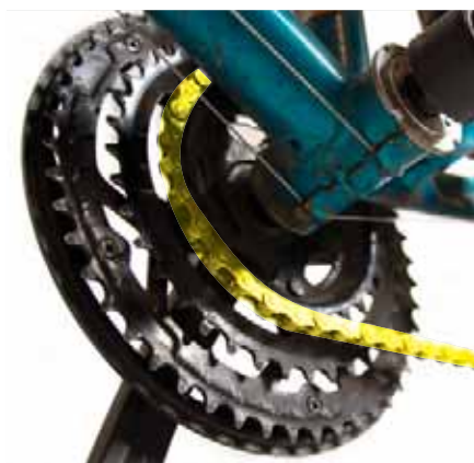
Quando tu cadena va en la estrella delantera más pequeña, el pedaleo es más fácil y avanzas menos. Ideal para subidas.
