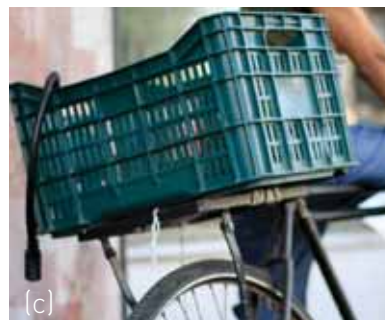
Una parrilla trasera en la que puedes colocar alforjas (a), una mochila con ganchos o con resortes (b), o una caja (d), es la mejor opción para carga pesada porque no desestabiliza a la bicicleta. Si amarras algo, cuida de no sujetar, doblar o tensar de más los cables de los frenos o los cambios.
